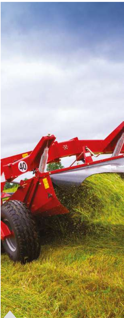
Pág. 12 Segadoras condicionadoras de disco MF: de arrasto
